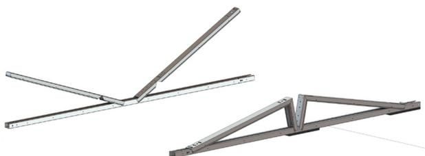
Fixez la partie mobile du triangle de montage au rail au moyen de vis à tôle ( $\varnothing$  6,5).
